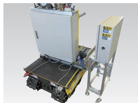
ワイヤレス給電装置による充電状況
