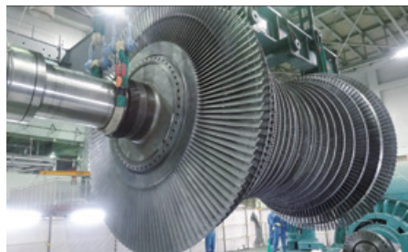
日本原子力発電(株) 東海第二発電所で実施中の低圧タービン点検
