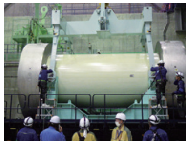
トレーラーからの金属キャスクのつり上げ作業*
