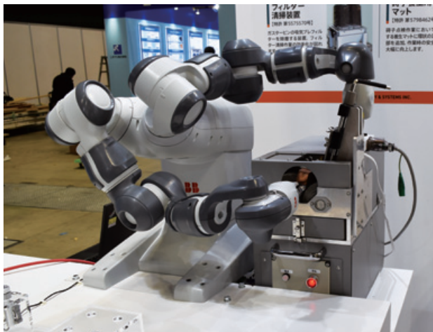
協働ロボットによるボルト磨き機のデモンストレーション
