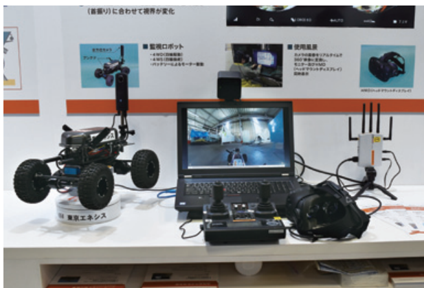
360°カメラを搭載した遠隔操作式監視装置
