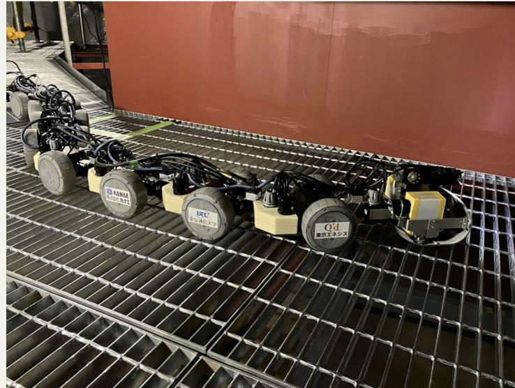
ヘビ型ロボット試験操作状況
