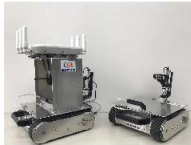
自走式中継機能付き 遠隔操作走行装置
